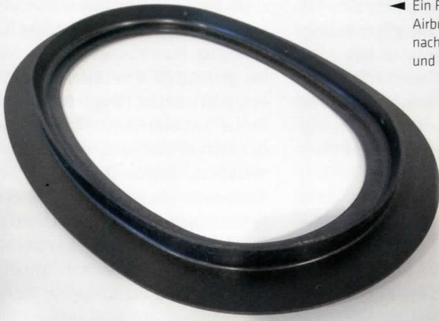
◀ Ein Fensterrahmen des Airbus A350-1000 aus CFK nach dem CNC-Beschnitt und vor der Lackierung
